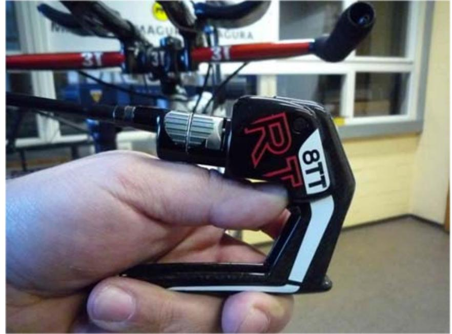
キャリパーの開いた状態を確認したら、クイックリリースを元に戻して、エア抜き作業に入ります。
