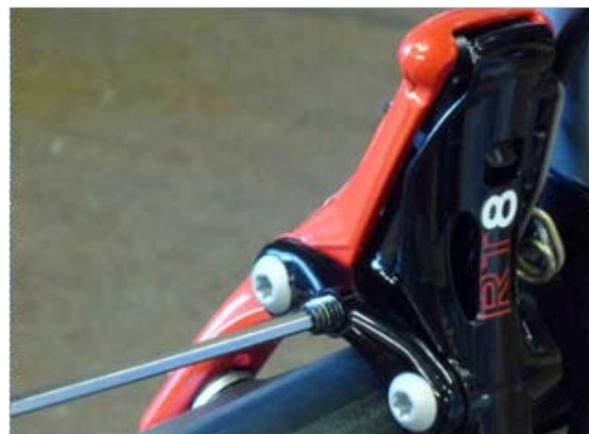
キャリパー側の注射器を取り外し、ブリード穴を閉じます。
