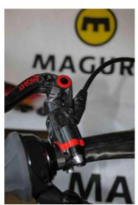
マスターのエア抜き穴をマグラロイヤルブラッドで満たし、EBTスクリューを規定トルクで締め込みます。 最大トルク O.5Nm
