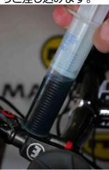
注射器をしっかりと押さえながら、ピストンを30mmの目盛りの穴のすぐ下まで引いた後、マスター側に押し込みます。これを3・4回繰り返します。
