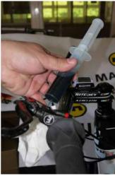
気泡が出なくなったら、ピストンを30mmの目盛りの穴の上まで引きます。 この時、マスターシリンダーにかかっていた圧力が抜けます。
