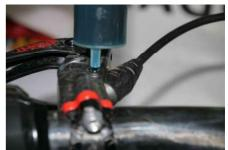
EBTスクリューを、T25トルクスレンチで取り外し、注射器の先端をしっかりと差し込みます。
