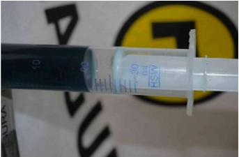
その注射器に、20mlのマグラロイヤルブラッドを吸い入れた後、5mlのエアを吸い入れます。 (ピストンは25mlの目盛りの位置になります。)
