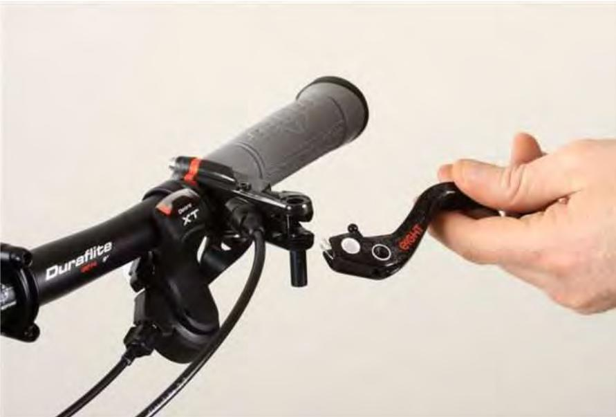
ピンを圧入したあと、カチッという音がしてピストンにロッドがはまるまでレバーブレードを引きます。
