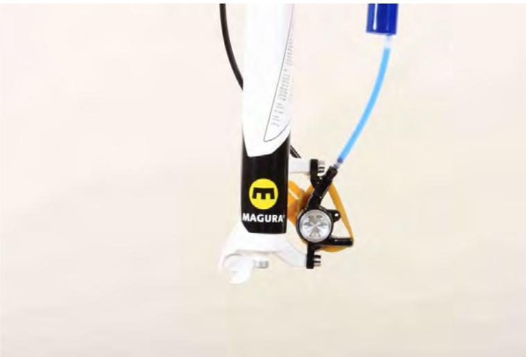
オイルを下の注射器から上側へ注入します。入れ切ったら下から吸います。
