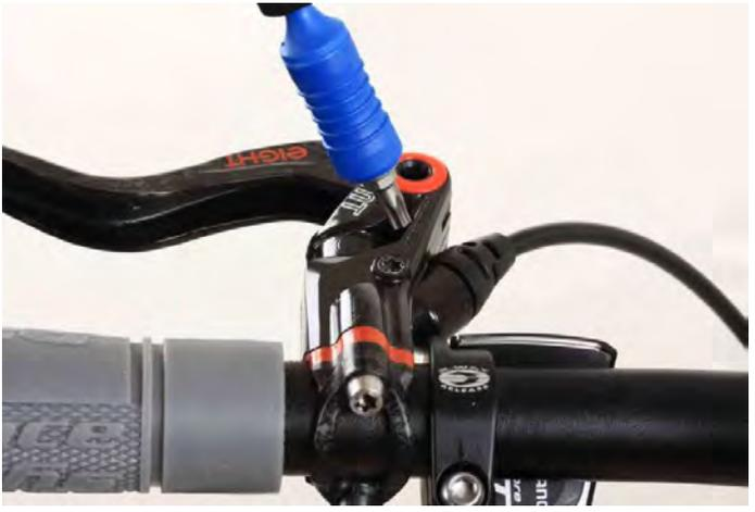
マスターのブリード穴から、注射器やプロブリードキットを取り外した後は、常にブリード穴がオイルに満たされているように注意してください。必要ならばオイルを注入してください。その状態でEBTスクリューを締め込みます。
