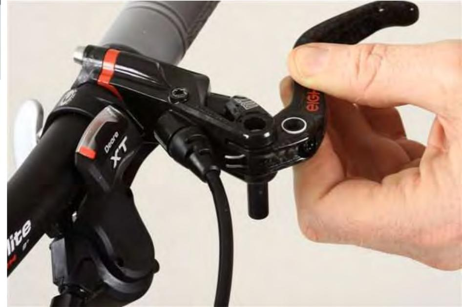
レバーブレードを外しても、ピストンは飛び出しません。
