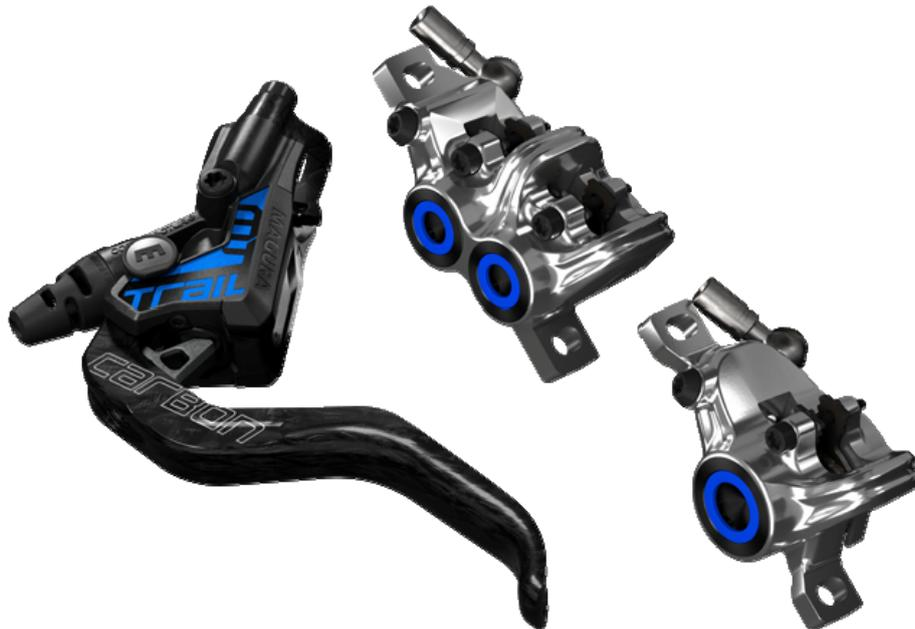
当商品は、一般的なマウンテントレイルを走行するMTBでの使用を主眼に置き、下り用途の強い制動力を保持しつつも、長距離の登攀も可能とする軽量化を果たしております。制動力を確保するため、フロントブレーキ側は MT7 ですでに定評のある 4 ピストンキャリパーとし、リアキャリパーは 2 ピストンキャリパー、またレバー側の材質を MT8 と同様のフルカーボン仕様とする事で、軽量化を果たしています。具体的には、MT7 の片側重量 375g に対し、片側の平均重量で 332g を達成しております。この数値は最軽量モデルの MT8 の数値(299g)と比べても、わずか 31g の重量増に留まります。
